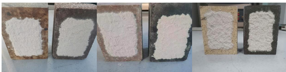
图11 1200℃硅莫砖-镁铁砖-镁铝砖-镁铬砖-高铝砖-铬刚玉砖煅烧10min黏连情况
