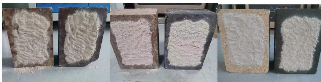
图7 850℃硅莫砖-镁铁砖-镁铝砖-镁铬砖-高铝砖-铬刚玉砖煅烧10min黏连情况
