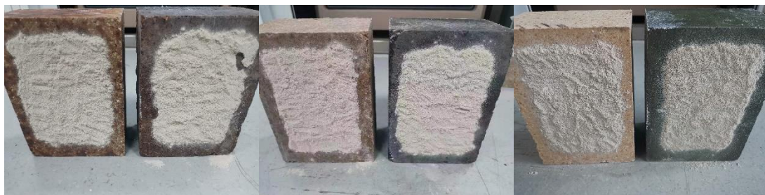
图8 900℃硅莫砖-镁铁砖-镁铝砖-镁铬砖-高铝砖-铬刚玉砖煅烧10min黏连情况
