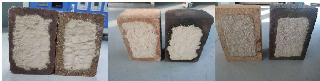
图12 1300℃硅莫砖-镁铁砖-镁铝砖-镁铬砖-高铝砖-铬刚玉砖煅烧10min黏连情况
