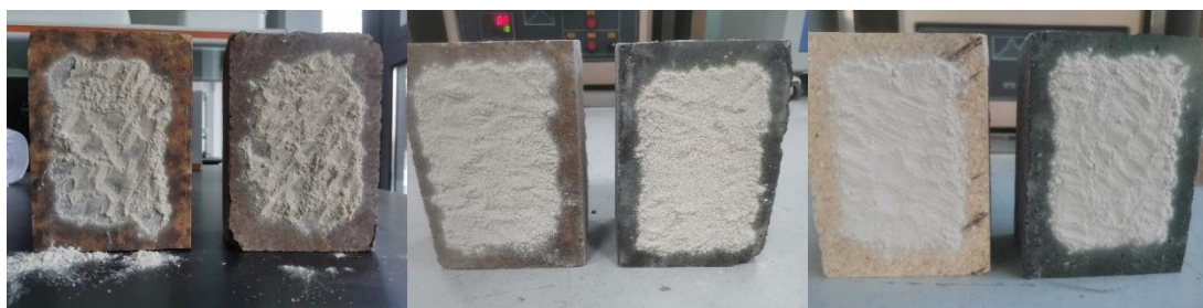
图9 1000℃硅莫砖-镁铁砖-镁铝砖-镁铬砖-高铝砖-铬刚玉砖煅烧10min黏连情况
