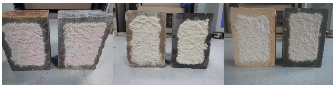
图10 1100℃硅莫砖-镁铁砖-镁铝砖-镁铬砖-高铝砖-铬刚玉砖煅烧10min黏连情况
