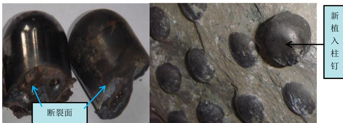
图 3 柱钉断裂照片图 4 新植入的柱钉
