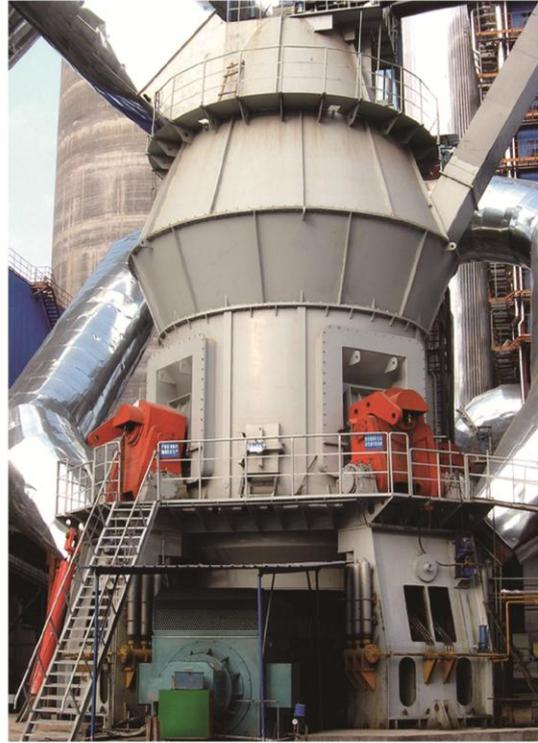
应用江西东亚水泥7000t/d水泥生产线的HRM4800B原料立磨
