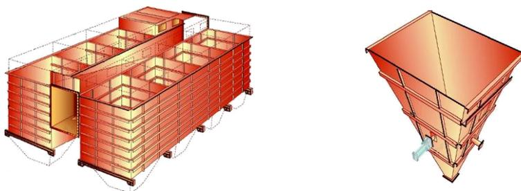
图 2 袋式除尘器内部模拟
