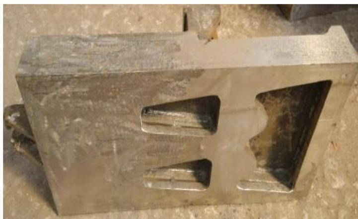
图 3 NCFG 篦板结构图
